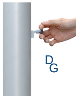
Entsperrstift ziehen, Riegel nach unten schieben: ENTSICHERN
